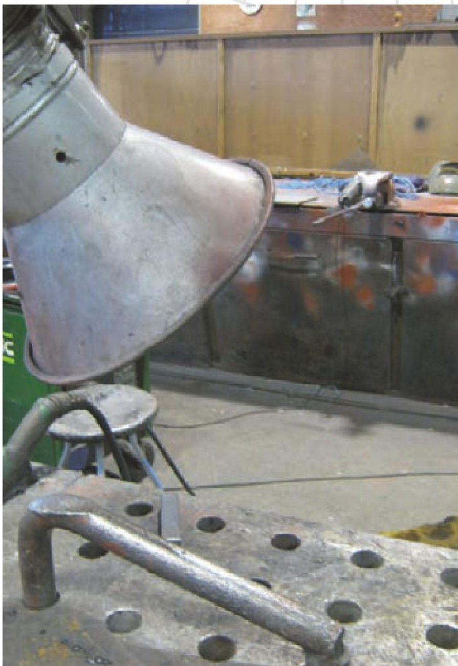
Wyciąg stanowiskowy umieszczony bezpośrednio nad obszarem roboczym.
