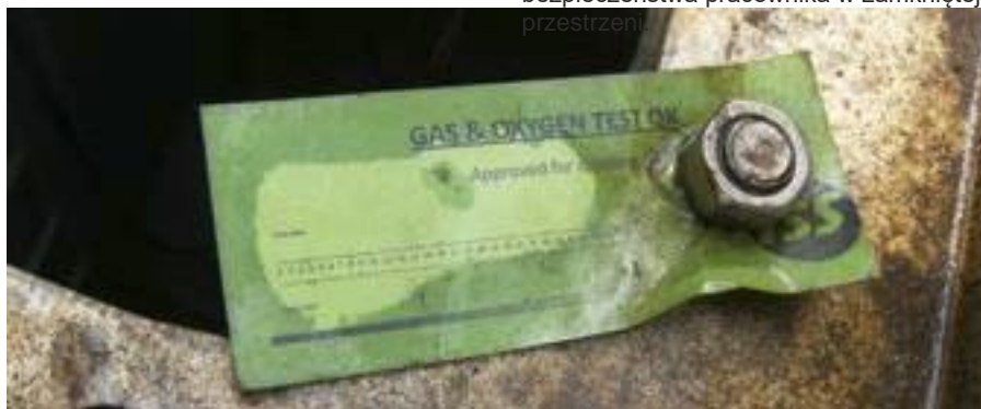
Zielona metka potwierdzająca, że zbiornik jest gotowy do wejścia..
