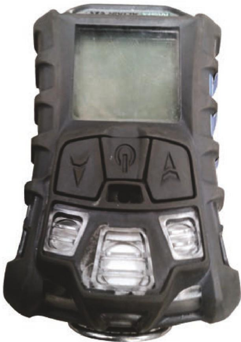
Tester gazów. Instrument do mierzenia stężenia gazów w powietrzu.
